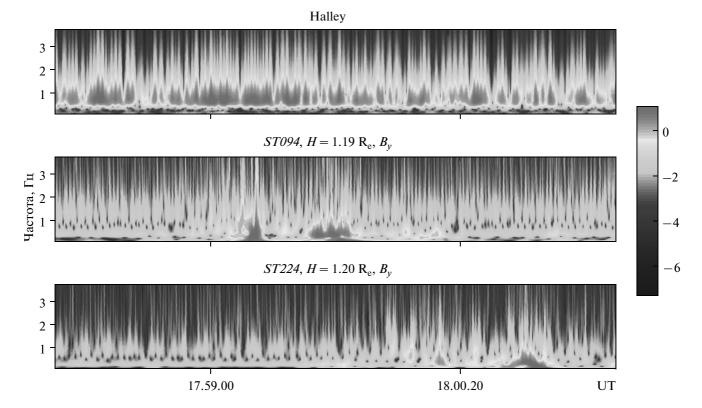
Рис. 8. Сопоставление вейвлет-спектров (гаусс, порядок = 3) излучения на наземной станции HLB и на спутниках.
