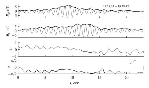
**Рис. 4.** Поляризационные параметры *ST094*. Поляризационные параметры, соответствующие амплитудам, меньшим уровня отсечки 0.75 от максимальной амплитуды, показаны тонкими линиями.
